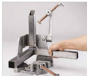
▶ der dritte Spannarm kann einfach weggedreht werden
