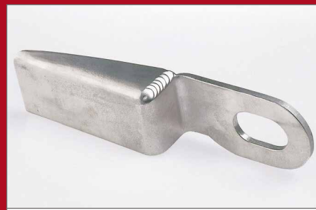
Schweißen von Aluminium mit WIG AC
