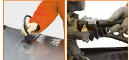
Zur Ausbesserung von Hagel-Dellen ohne Beschädigung des Lackes
