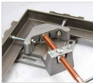
▶ mit Vorrichtung zur besseren Klemmung von Profilen
