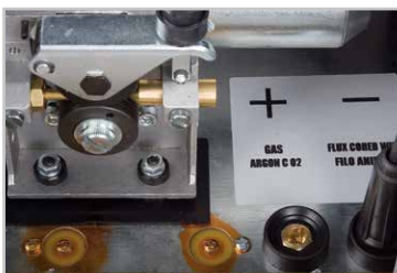
Umpolung für die Verwendung von Fülldrähten bei Kombi 170 ED
