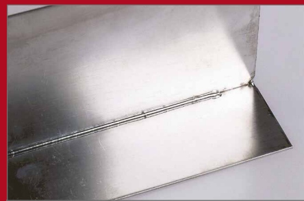
Schweißen von Cr-Ni-Stahl mit WIG
