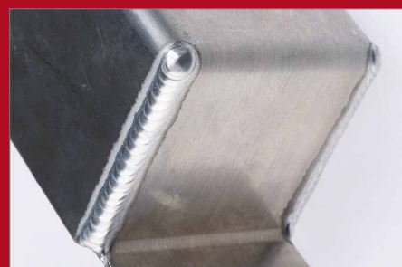
Schweißen von dünnem Aluminium mit WIG AC
